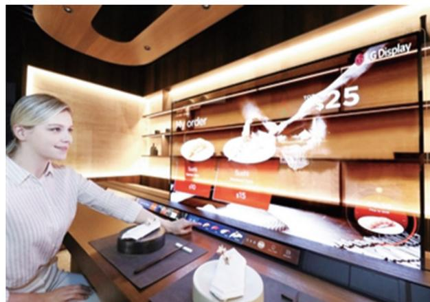
这款产品面板拥有自发光像素，每个像素都能够独立的开启和关闭，基于这种原理生产出了“透明电视”。透明OLED电视在通电的情况下看上去就像一台普通电视，但当关闭的时候，就像是贴了一层薄膜的透明玻璃，在它后方的物体都能清晰可见。
