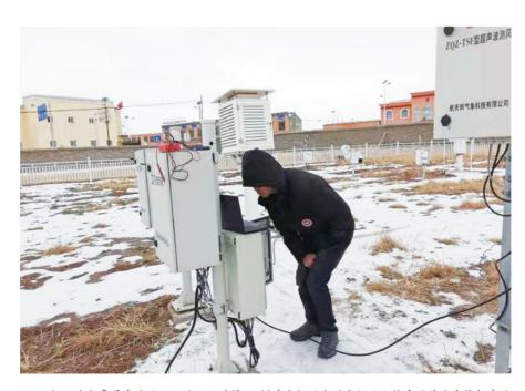
近日,省气象局在地处可可西里五道梁、玉树清水河两个国家级无人值守站首次安装超声风传感器,该传感器也是我省国家级台站首次采用超声风设备。据介绍,超声风传感器依靠其无惯性测量、一体式结构设计、随机误差识别技术,使数据更准确和稳定,设备使用寿命更长,减轻了台站技术人员的工作量,降低了维护成本。图为工作人员在清水河气象站安装超声风传感器。
