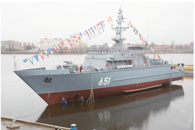
据中新社报道,11月26日,俄罗斯“阿纳托利·什列莫夫”号12700型扫雷舰在圣彼得堡中涅瓦造船厂下水。这是俄建造的第七艘12700型“变石”级基地扫雷舰,由俄“金刚石”中央海军设计局研制。扫雷舰舰体整体灌注玻璃纤维材料,不仅能发现水中水雷,还能有效探测到海底的布雷。
