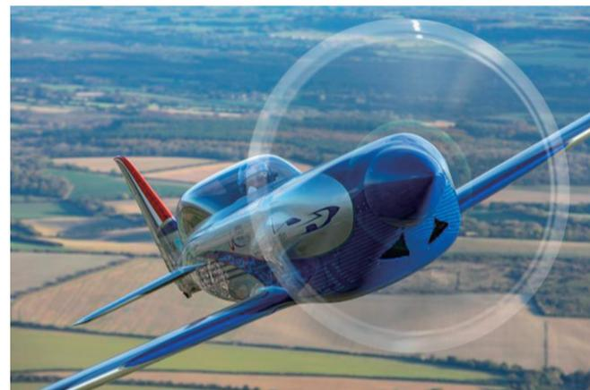
据《光明日报》报道,近日,劳斯莱斯旗下的“创新精神”电动飞机在一个实验性飞机测试场的测试飞行中,最高速度达到了623公里/小时。据悉,“创新精神”由一个400千瓦的动力系统驱动,该系统由三个发动机连接到一个6480个电池组,这是迄今为止为飞机制造的功率密度最高的电池。
