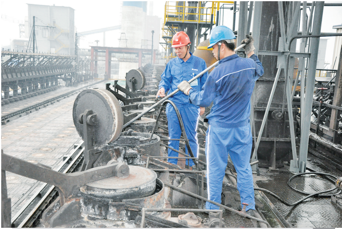
山西焦化股份有限公司焦化厂第一炼焦车间时刻绷紧安全生产弦，抓实抓细安全防范工作，坚决守住安全生产底线。图为5月14日工艺丙班班长郭进(左)正带领工人清理焦炉上升管。
