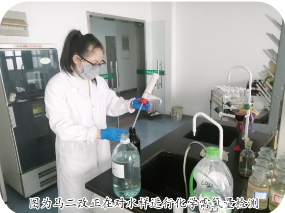
图为马二改正在对水样进行化学需氧量检测
